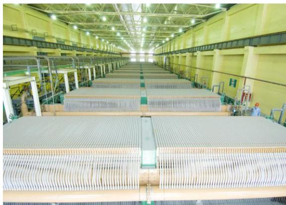
◆脱氯淡盐水采用先进的膜法脱硝，淘汰了落后的氯化钡脱硝工艺；
