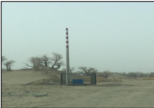
3#地下水监测井
